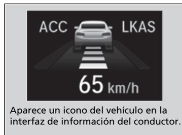
Cuando un vehículo con una velocidad inferior a la suya programada se acerca por delante o se cuela delante y es detectado por el radar y la cámara, su vehículo comienza a reducir la velocidad.
