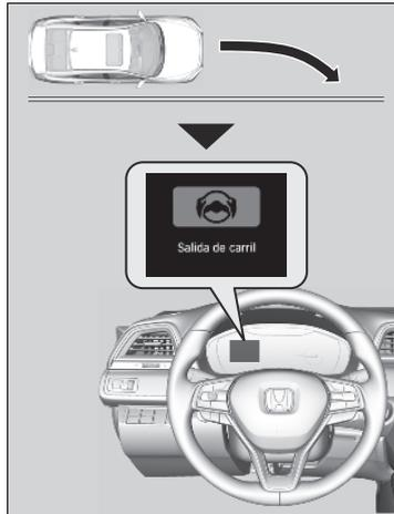
La cámara frontal detrás del espejo retrovisor supervisa las marcas de carril de los lados izquierdo y derecho (blancas o amarillas). Si el vehículo se acerca demasiado a las marcas del carril detectadas sin que se haya activado un intermitente, el sistema, además de emitir una alerta visual, aplica par a la dirección y alerta con vibraciones rápidas del volante, para ayudarlo a permanecer dentro del carril detectado.
