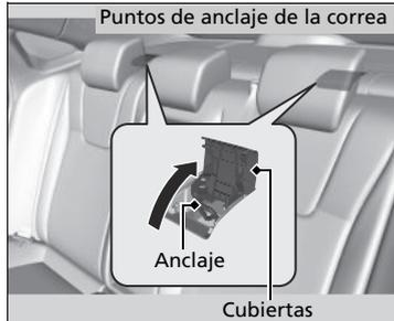
Hay un punto de anclaje para la correa de sujeción detrás de cada asiento trasero exterior. Si dispone de un sistema de sujeción infantil que incluye una correa de sujeción pero que se puede instalar con cinturón de seguridad, puede utilizar la correa para obtener una mayor seguridad.
