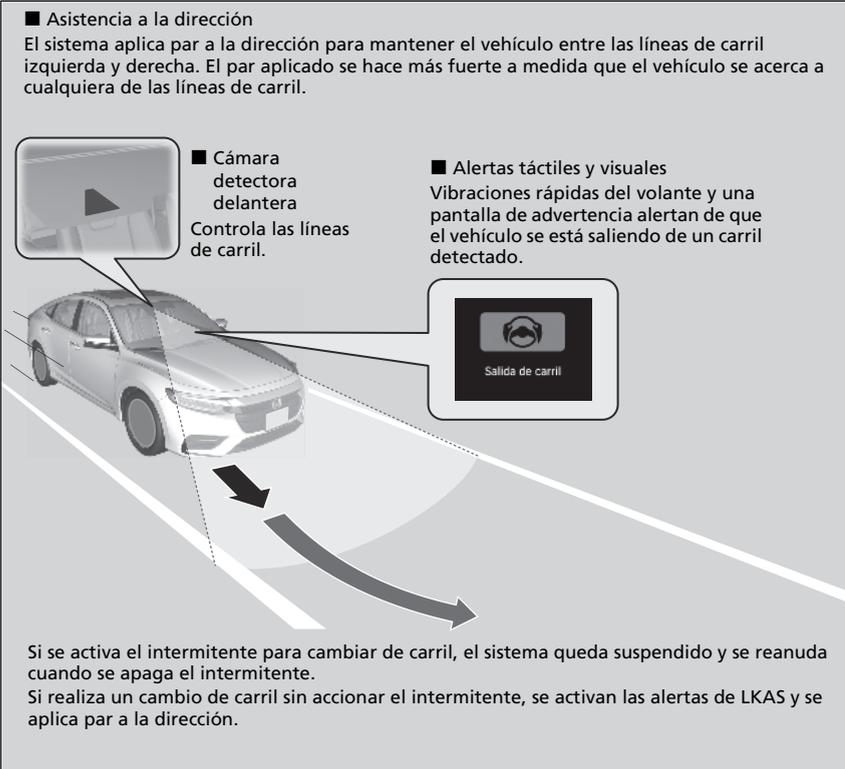
Si se activa el intermitente para cambiar de carril, el sistema queda suspendido y se reanuda cuando se apaga el intermitente.
