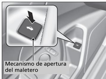
Mantenga pulsado el dispositivo de apertura del maletero en la puerta del conductor para desbloquear y abrir el maletero.
