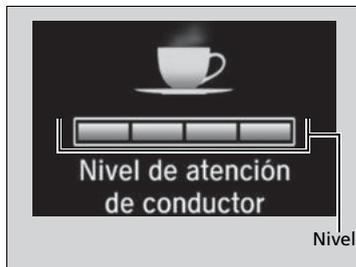
Al seleccionar **Atención de chófer** en la interfaz de información al conductor, se iluminan las barras en blanco para indicar el grado de atención del conductor.
