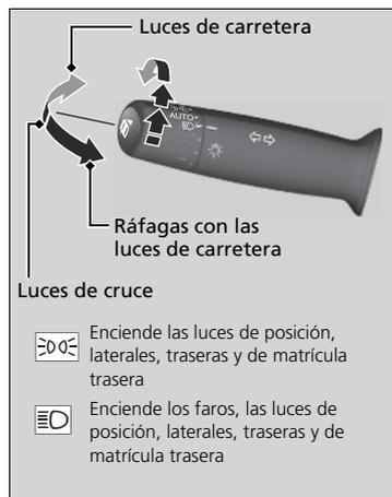
Al girar el interruptor de luces se encienden y apagan las luces, con independencia del ajuste de la modalidad de alimentación.
