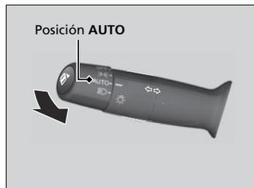
Desactive o vuelva a activar el sistema cuando el vehículo esté estacionado con el modo de alimentación a CONTACTO y el interruptor de luces en la posición **AUTO**.
