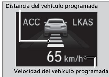
Cuando el ACC con LSF comienza a funcionar, el icono del vehículo, las barras de distancia y la velocidad programada aparecen en la interfaz de información al conductor.
