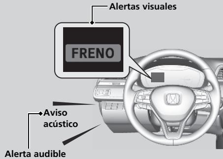
En la fase de alerta de colisión más temprana del sistema, puede cambiar la distancia (**Larga/Normal/Corta**) entre vehículos a la que se activan las alertas a través de las opciones de configuración de la pantalla de audio/información.
