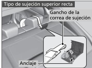
1. Localice el punto de anclaje de la cinta de sujeción correspondiente y levante la tapa.
