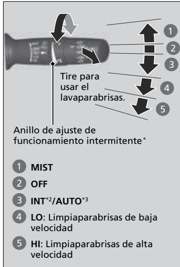
El limpia/lavaparabrisas se puede utilizar cuando el interruptor de encendido está en la posición de CONTACTO \*1.
