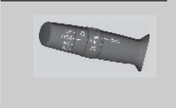
El sistema de luces automáticas se puede utilizar con el interruptor de encendido en la posición de CONTACTO \*1.
