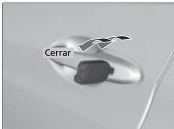
**Para cerrar:** Bloquee la puerta del conductor con la llave. Antes de que transcurran 10 segundos desde que la llave se colocó de nuevo en la posición central, gire la llave en el sentido de bloqueo y manténgala en esa posición.
