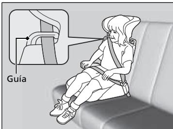
Hay disponible un respaldo para un elevador determinado. Instale el respaldo en el elevador y ajústelo al asiento del vehículo siguiendo las instrucciones del fabricante del elevador. Asegúrese de que el cinturón de seguridad se pasa correctamente a través de la guía del hombro del respaldo y que el cinturón no toca ni cruza el cuello del niño.
