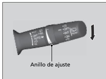
Al bajar la palanca hacia **AUTO**, los limpiaaparabrisas efectúan un barrido y pasan a la modalidad automática.
