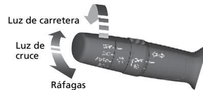
Modelos con interruptor de posición automática predeterminada
