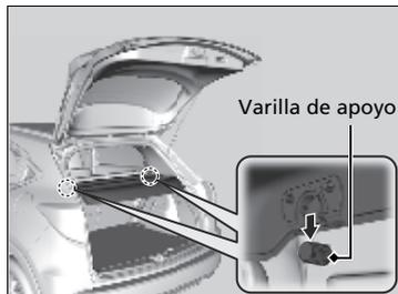
3. Desenganche las varillas de soporte y, a continuación, retire la cubierta del maletero.
