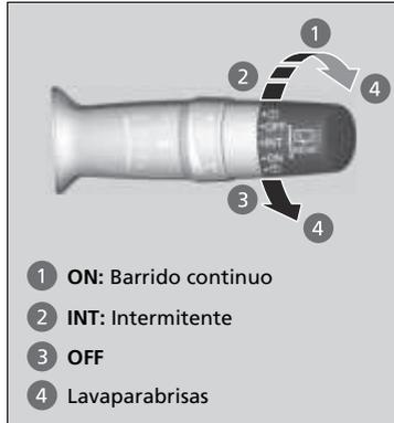
El limpia/lavaparabrisas trasero se puede utilizar cuando el interruptor de encendido está en la posición de CONTACTO **II**\*1.
