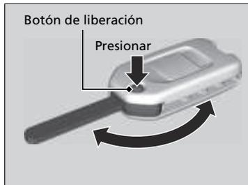
La llave se pliega en el interior del control a distancia.
