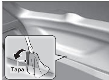
1. Cubra con un paño la punta del desarmador de punta plana. Colóquelo en la cubierta, como se muestra en la imagen, y abra la cubierta.
