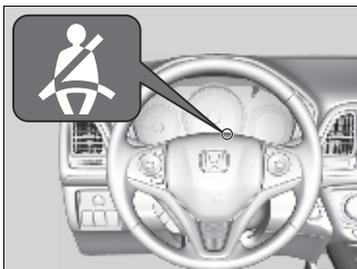
El sistema del cinturón de seguridad incluye un indicador en el tablero de instrumentos para recordar al conductor, al acompañante\* o a ambos que deben abrocharse los cinturones.
