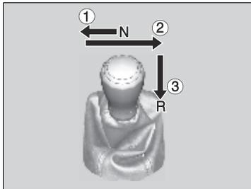
1. Pise el pedal de embrague, mueva la palanca de cambios hacia la izquierda hasta el tope y cambie a **R**.
