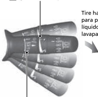
Tire hacia usted para pulverizar líquido lavaparabrisas.
