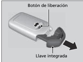
Se puede utilizar la llave integrada para bloquear/desbloquear las puertas cuando la pila del control a distancia de acceso sin llave se esté agotando y la función de bloqueo/desbloqueo eléctrica de las puertas esté deshabilitada.
