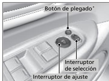
Puede ajustar los retrovisores cuando el interruptor de encendido está en la posición de CONTACTO **II**\*1.
