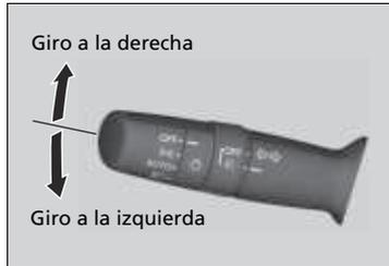
Los intermitentes se pueden utilizar cuando el interruptor de encendido está en la posición de CONTACTO
