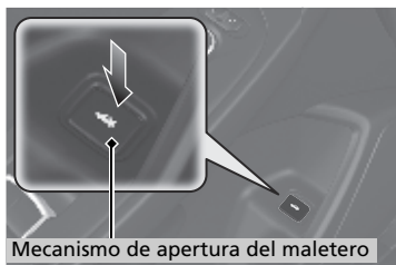
Mecanismo de apertura del maletero
